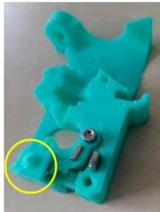
Vložte větší magnet do dílu extruder-body. Magnety se musí navzájem odpuzovat a FS-lever bude posunutý doprava.
