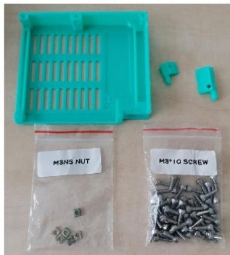
Vložte matku do otvoru dvířek elektroniky co nejhлouběji. Do spodního pantu (einsy-hinge-bottom) vložte šroub M3x10.
