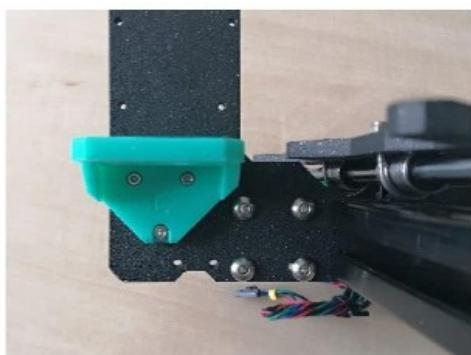
Otočte si tiskárnu delšími extruzemi k sobě. Pomocí trojice šroubů našroubujte držáky. Pozor na správné osazení dílů. Levý držák má menší díru vlevo, pravý vpravo.
