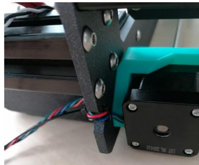
3. Kabely upevňujte směrem nahoru a vytvořte další smyčku pomocí stahovací pásky. Do smyčky vložte kabel motoru osy Z a všechny kabely ze zdroje. Pásku utáhněte a zbytek ustříhněte.
