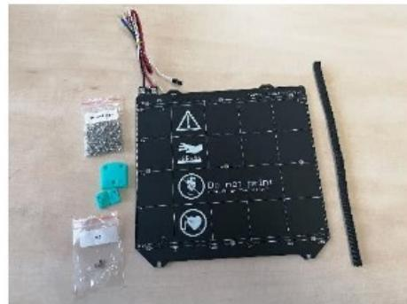
Do spodního dílu Heatbed-cable-cover vložte matky M3n.
