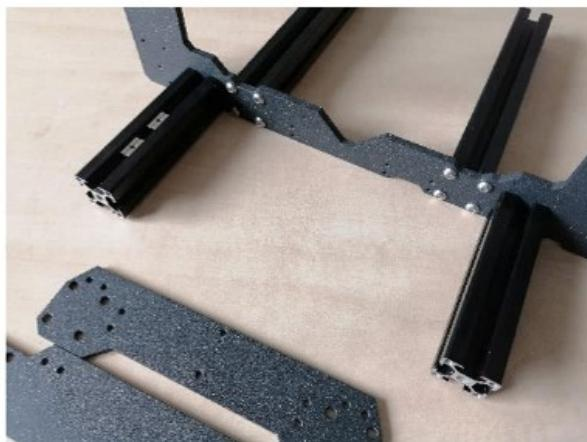
Do kratší extruze na straně, kde jsou díry pro zdroj, vložte matice 3030 M4 Square Nut, jako na fotce vlevo. Přišroubujte (M5x16r 8 ks) kratší desku.
