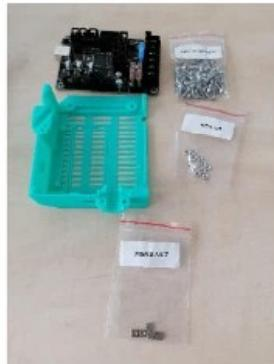
4 matky M3nS vložte do děr v einsy-base. Zbylé 4 matky M3n vložte z vnější strany do připravených děr. Nasuňte desku do krytu a připevněte šrouby (šroubuje opatrně, deska se může poškodit).
