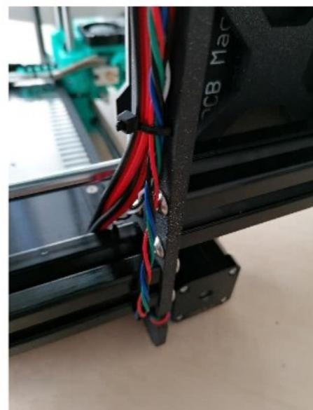
2. U motoru osy Z prostrčte stahovací pásku skrz otvory v rámu a vytvořte smyčku. Vložte kabel do stahovací pásky a utáhněte. Zbytek pásky ustříhněte.
