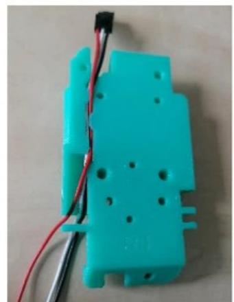
Na kabelu IR senzoru najděte konec s menším konektorem. Kabel veděte skrz drážku v dílu X carriage a veďte jej pod výstupky. Vzdálenost konektoru od dílu by měla být 15 mm.
