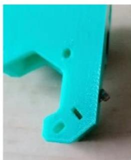
Vezměte si díl X-end- motor a matku M3nS. Vložte matku a šroub do otvorů. Utáhněte šroub tak, aby nezasahoval do otvoru pro další šroub.
