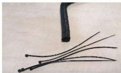
Otevřete jeden konec rukávu a nasadte jej na svazek kabelů se strunou. Délka zabalené části by měla být cca 5 cm. Zakruťte rukávem pro zmenšení jeho průměru a zasuňte jej směrem k extruderu.
