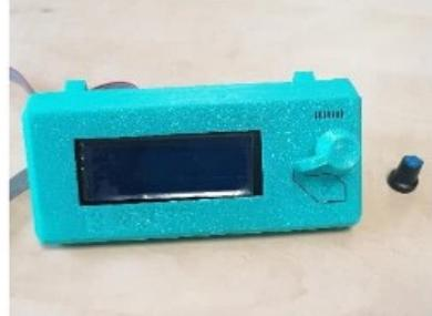
Nasuňte úchyty na LCD. Z displeje odstraňte knoflík a zasuňte LCD do dílu LCD-cover. Upravte pozici držáků. Po nasazení LCD se musí ozvat „kliknutí“ na středu dílu. Přišroubuje LCD k LCD cover ve spodní části pomocí dvou šroubů M3x10 a 2,5mm imbusového klíče.
