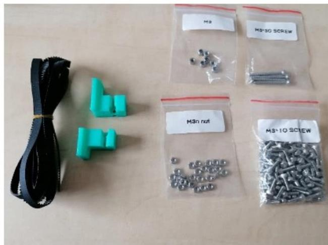
Do dílu Y-belt holder vložte na doraz obě matky M3n a M3 (M3 vložte ve směru řemene, viz 3. obrázek). Kolem šroubu M3x10 ohněte konec řemene. Zatlačte řemen do držáku. Celá ohnutá část musí být v celé šířce tištěné části. Zubý řemenu musí směřovat nahoru. Dotahujte šroub tak, aby se chytil do matice.
