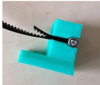
Pomocí šroubu M3x10 upevněte Y-belt tensioner k dílu Y-carriage (díra vpravo). Šroub zcela nedotahujte. Vložte šroub M3x30 skrz oba díly. Dotahujte ho, než se chytí matice.
