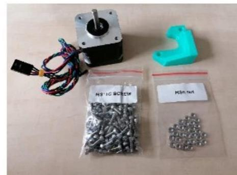
Vezměte plastový díl a vložte do něj dvě matky M3n. Díl položte na motor (pozor na správnou orientaci) a přišroubujte.
