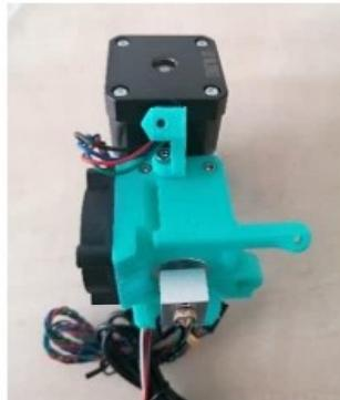
Vložte matku M3n a zatlačte ji do díry v plastovém dílu. Díl umístěte na extruder tak, aby nakloněná část směřovala dolů a přišroubujte.
