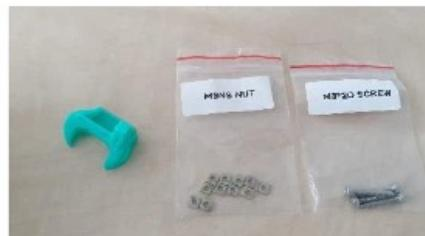
Matku vložte do čtvercové díry dílu fan-shroud. Umístěte díl na extruder a přišroubujte. Dotahujte opatrně a zkontrolujte, že se ventilátor extruderu může otáčet.
