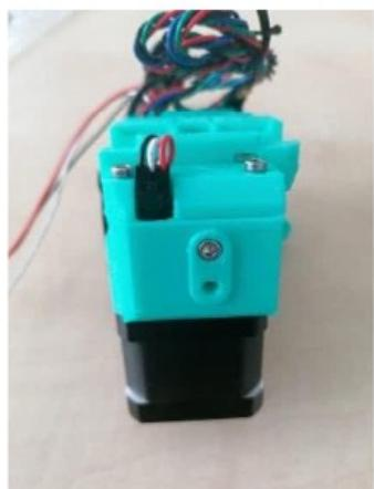
Položte plastový díl na extruder a zarovnejte hrany. Do díry dál od motoru zašroubujte šroub.
