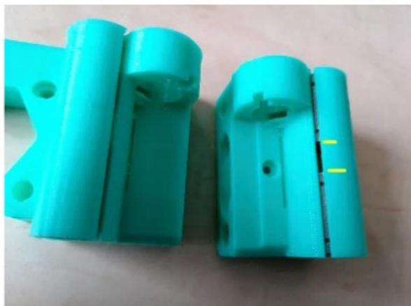
Vložte lineární ložiska do vytiskněných dílů, viz obrázek. Vnitřní kuličky prvního ložiska by mely být pootočeny o  $45^\circ$ . Ložiska se vkládají z vrchní strany (v tištěném dílu je osazení pro snadnější vložení ložiska). Ložiska mají být zarovnaná k okrajům.
