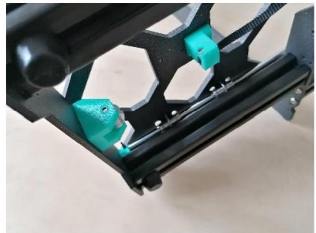
Do dílu Y-belt tensioner vložte matku M3n až nadoraz. Kolem šroubu ohněte konec řemene a zatlačte do držáku. Ohnutá část je v celé šířce tištěné části. Zubý řemenu směřují nahoru. Dotahujte šroub tak, aby se chytil do matice.
