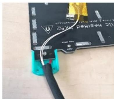
Kabel termistoru veďte pod kabelem pro napájení vyhřívané podložky. Oviňte textilní rukáv okolo kabelů z vyhřívané podložky. 5-6 mm rukávu zasuňte směrem do krytky a zavřete druhým dílem krytky. Ujistěte se, že kabely nejsou skřípnuté a dotáhněte krytky dvěma šrouby M3x10 (v případě problémů použijte delší šrouby M3x12).
