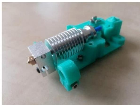
Dva šrouby M3x10 vložte do otvorů (viz obrázek). Do extruder-body vložte hotend, kabely by měly směrovat dozadu.
