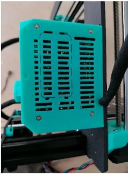
Před nasazením krytu na rám zapojte kabel od motoru osy X. Textilní oplet zatlačte do drážky v krytu a kabel nenapínejte. Na krytu elektroniky najděte drážky, které slouží pro nasazení na šrouby.
