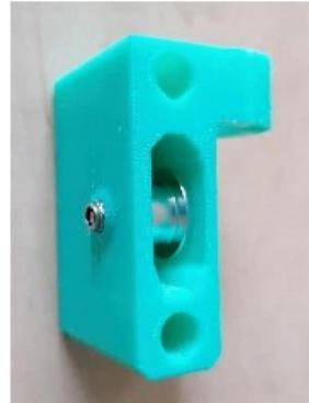
Vezměte si díl X-end idler, samojistnou matku M3, kladku a šroub M3x18. Vložte samojistnou matku do dílu. Mezi plastové části vložte kladku a zajistěte ji pomocí šroubu. Šroub dotáhněte tak, aby šlo s kladkou volně otáčet.
