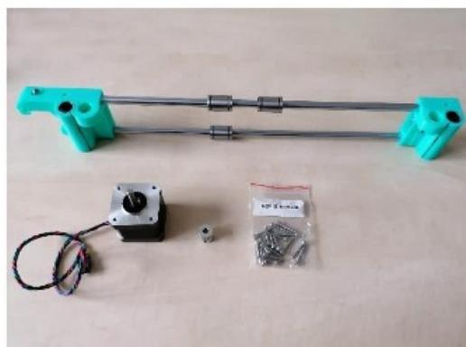
Nasadte řemenici na hřídel motoru. Mezi řemenicí a motorem ponechte prostor. Červík míří na plochu hřídele. Dotáhněte oba červíky řemenice.
