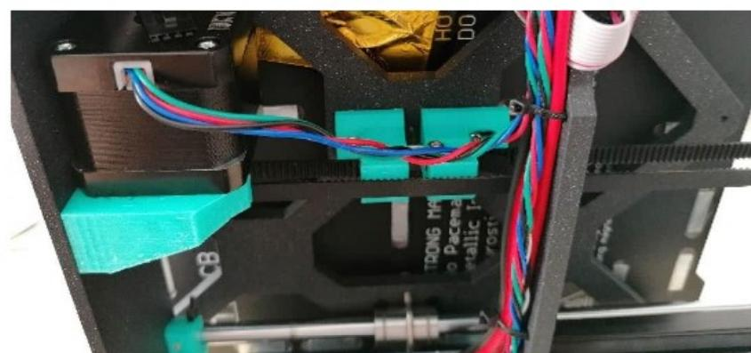
4. Opět pokračujte nahoru a vytvořte smyčku. Ke kabelům přidejte kabel motoru osy Y. Pásku dotáhněte a zbytek ustříhněte.
