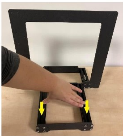
Obrázek 29 Správný způsob „naklání“ tiskárny k zjištění, které rohy se zvedají
