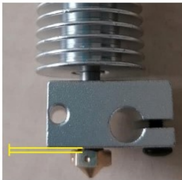
Obrázek 28 Mezera mezi tryskou a vyhřívanou kostkou při plném dotažení
