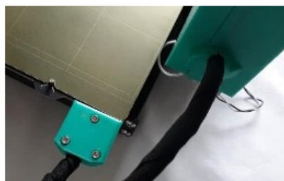
Obrázek 32 Kabely omotané stahovacím rukávem na kabely
