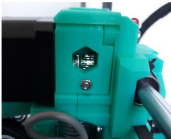
Obrázek 27 Čistící otvor tiskové hlavy
