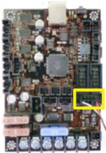
Obrázek 25 Správné zapojení kabelu IR senzoru filamentu
