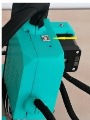
Obrázek 15 Pozice USB portu na 3D tiskárně
